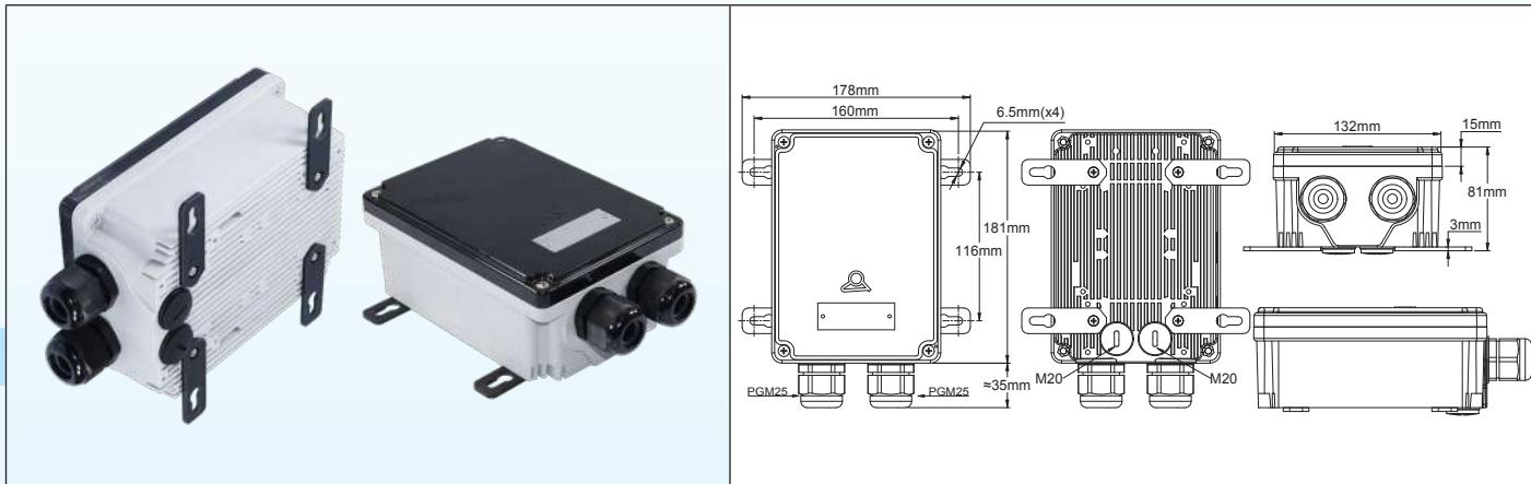
Queste scatole sigillate in alluminio sono vernicate con vernice epossidica RAL 7015. Hanno le stesse dimensioni delle scatole di comando in plastica e utilizzano coperchi piatti. Utilizzano le stesse lingue di montaggio a parete dei modelli in plastica. Sono state progettate per il montaggio di relè a stato solido monofase o trifase il cui raffreddamento è assicurato dalle alette sul lato posteriore.
