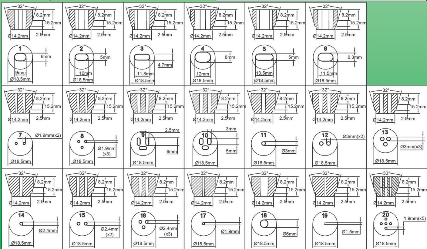
Disponibili per cavi piatti o rotondi, fili e capillari. Le loro parti posteriori hanno una punta conica elastica che si stringe sul conduttore. Vengono compressi dai dadi in ottone M20.
