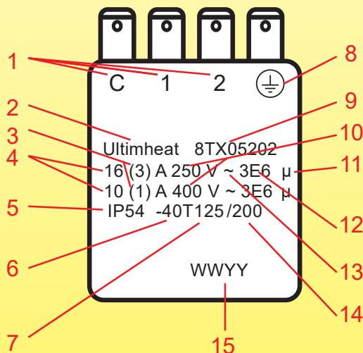
1: Identificazione dei morsetti adatti al collegamento di conduttori esterni e se sono adatti ai conduttori di linea o di neutro o a entrambi.
