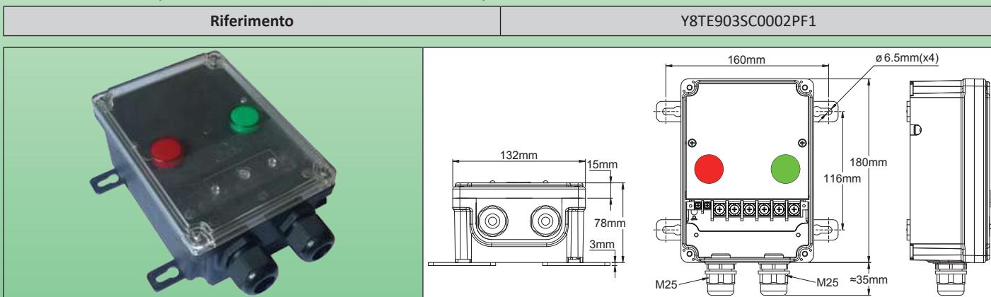
3 x 25A (AC1), 250V, morsettiera con 2 morsetti a vite da 2.5mm<sup>2</sup> e 6 morsetti a vite da 10mm<sup>2</sup>. Spia rossa per l'alimentazione e spia verde in uscita (250V), coperchio trasparente.
