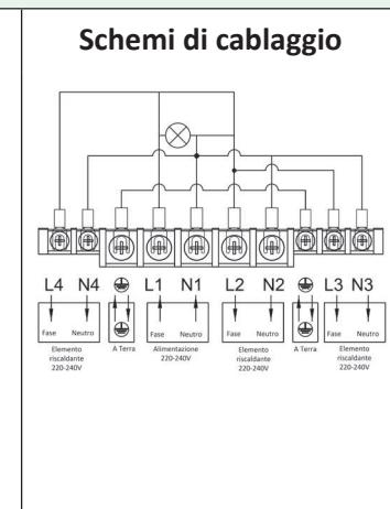
**Cablaggio:** alimentazione Neutro + Fase + Terra su una morsettiera da 6 mm<sup>2</sup> e uscite su 3 prese del circuito di riscaldamento da 1.5 o 2.5 mm<sup>2</sup>.
