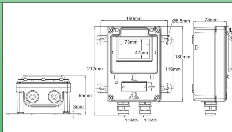
Consente il montaggio di un interruttore automatico tipo Merlin Gerin Multi 9 (UL, CSA, IEC) e delle gamme europee equivalenti Vigi C60 o C60 (72 mm di larghezza massima = quattro moduli da 18 mm), o dei controller elettronici descritti in questo catalogo.
