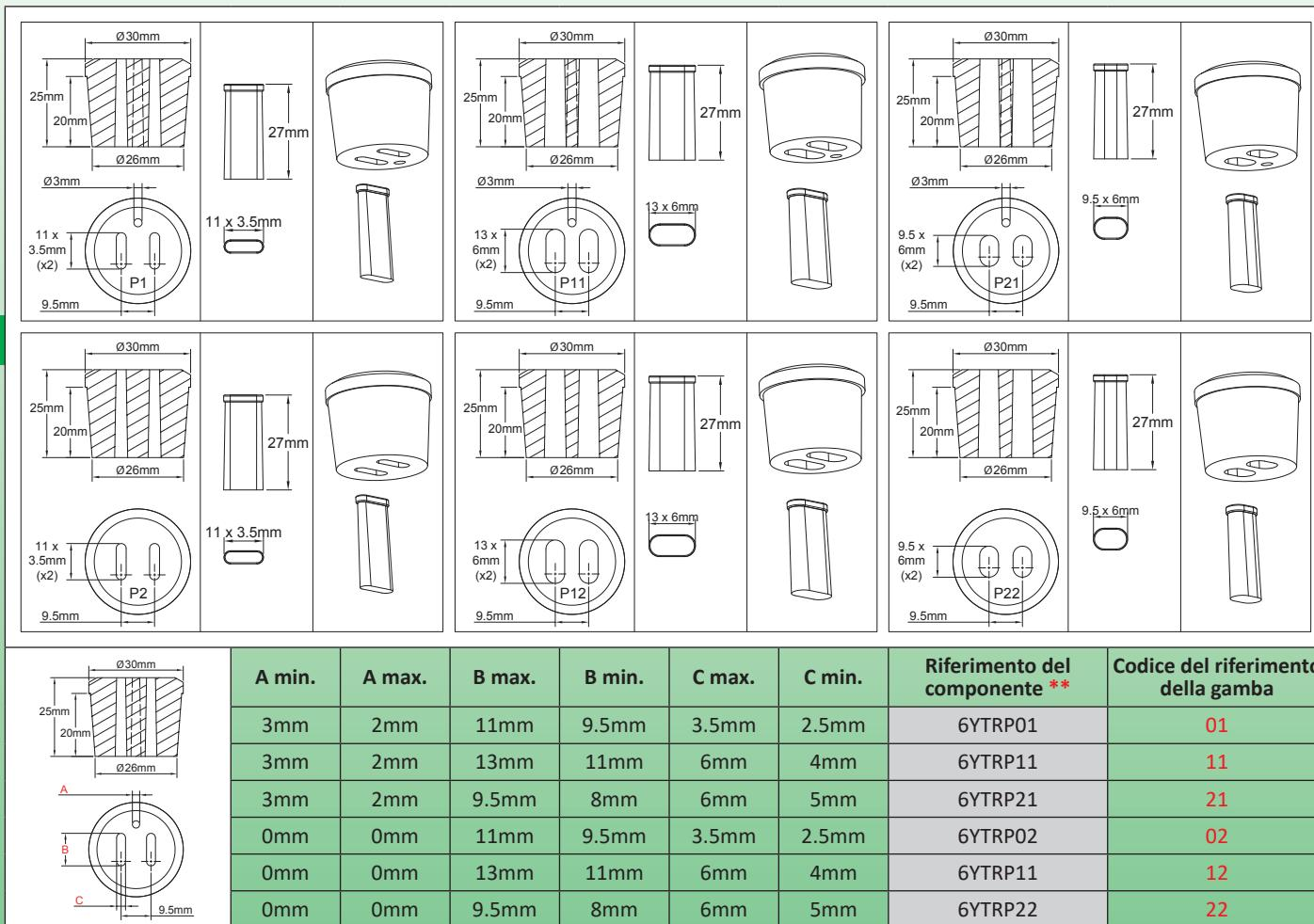
\* Le guarnizioni di tenuta sono fornite con un tappo che consente di chiudere uno dei 2 orifizi per i cavi scaldanti, per i casi in cui il piede utilizza un solo cavo scaldante.
