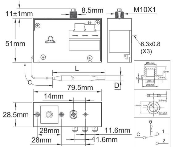
**Dimensioni dell'alloggiamento:**  $79.5 \times 51 \times 28.5$  mm (6.3 terminali a connessione rapida e pulsante di reset manuale non inclusi)
