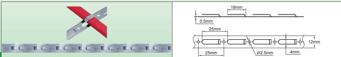
Banda per il tracciamento elettrico, larghezza 12 mm, passo di 25 mm, in bobina
