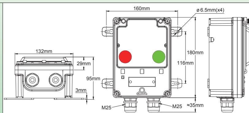
3 x 16A (AC1), 250V, morsettiera con 5 morsetti a vite da 2.5mm<sup>2</sup> e 5 morsetti a vite da 6mm<sup>2</sup>. Spia rossa per l'alimentazione e spia verde in uscita (250V), finestra trasparente.
