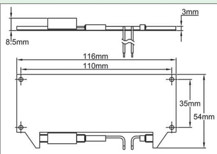
Immediatamente sotto il livello della finestra trasparente, il flusso d'aria calda che genera impedisce la formazione di condensa sulla finestra e mantiene una temperatura ambiente ottimale per i dispositivi di controllo nell'alloggiamento. È dotato di un ampio scambiatore di calore in alluminio per ridurre la temperatura superficiale e un termostato a scatto miniaturizzato limita la temperatura all'interno dell'armadio.
