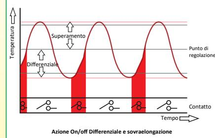
**Differenziale regolabile:** Un differenziale basso è spesso associato alla precisione del controllo. Tuttavia, un differenziale troppo basso provoca cicli brevi di riscaldamento e l'usura prematura dei contatti se si utilizza un relè di potenza, oppure un rapido degrado del compressore se il sistema viene utilizzato per controllare un frigorifero. I regolatori elettronici di questo catalogo hanno un differenziale regolabile per ottimizzare questo funzionamento.
